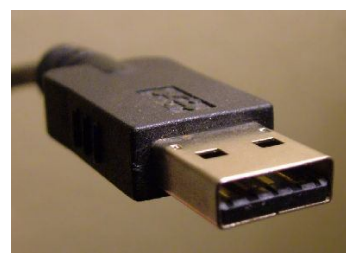
Rysunek przedstawia wtyczkę USB typu A
