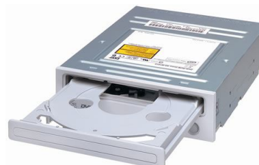
Rysunek przedstawia napęd CD-ROM
